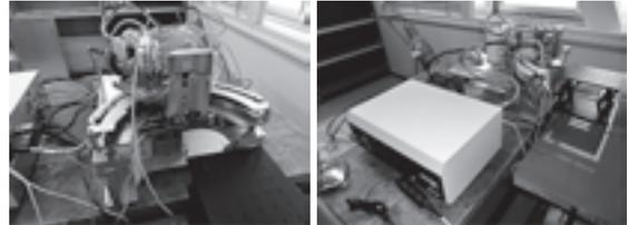
図1 ポータブルX線回折・蛍光X線分析装置
