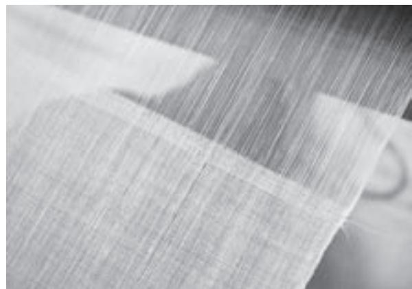
近江の地機で麻糸を用いて織っていただき、復元織機にかけた様子(左)。復元織機で1cmほど織ると、右写真のように、織機が変わったことによる糸の張力などの違いで織り目が違うのがわかる。
